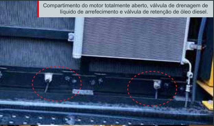
Compartimento do motor totalmente aberto, válvula de drenagem de líquido de arrefecimento e válvula de retenção de óleo diesel.
