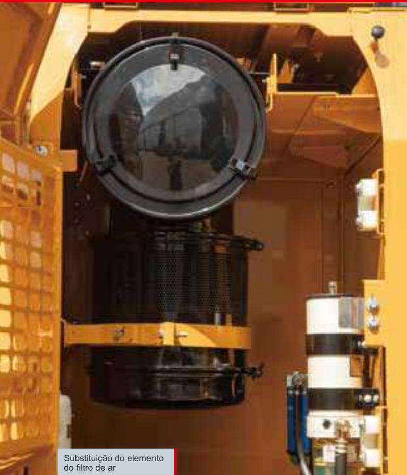
Substituição do elemento do filtro de ar
